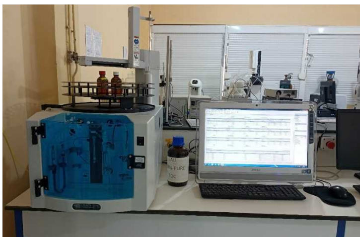
Figure 15 : Analyseur TOC (TELEDYNE TEKMAR).
